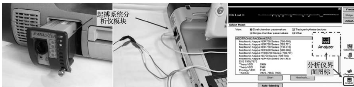
图 26 使用程控仪的起搏系统测试分析模块进行参数测试 [ 以美国美敦力公司 2290 起搏系统分析仪为例, 将起搏系统测试分析模块插入程控仪, 连接测试线与过桥线, 进入分析仪界面开始参数测试 ]
