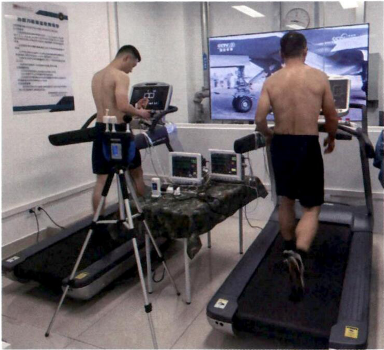
注：热耐力检测实验室配置包括跑步机、心电和直肠温度监护仪、黑球温度计、空气二氧化碳浓度检测仪、电视等。一般情况下，受试人员需要在室温 40℃ 和相对湿度 40% 的环境条件下，在坡度为 2% 跑步机上以 5 km/h 的速度行走 120 min。热耐力指数是在暴露结束时根据心率和核心温度的变化计算确定
